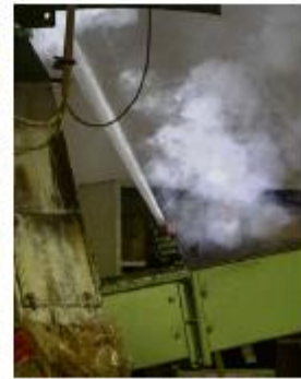
Löscharbeiten an der Förderschnecke.
